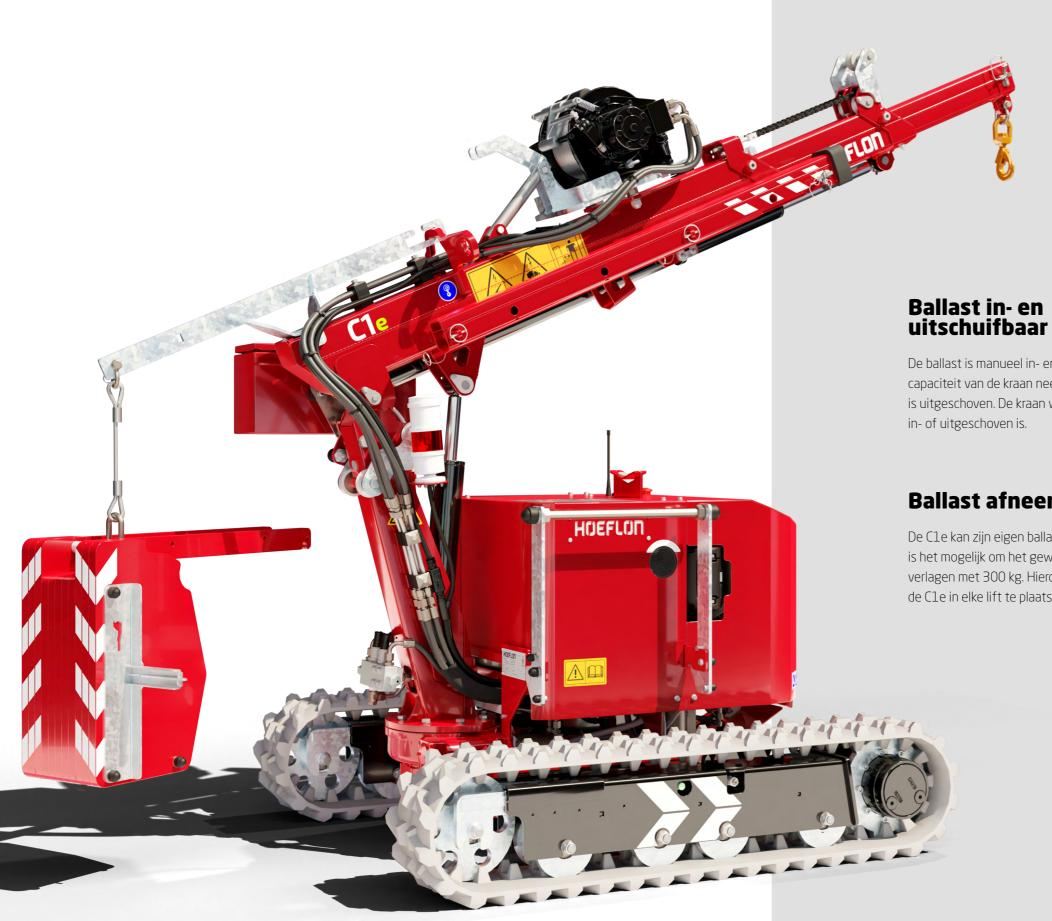
De ballast is manueel in- en uitschuifbaar. De capaciteit van de kraan neemt toe als de ballast is uitgeschoven. De kraan weet zelf of de ballast in- of uitgeschoven is.
